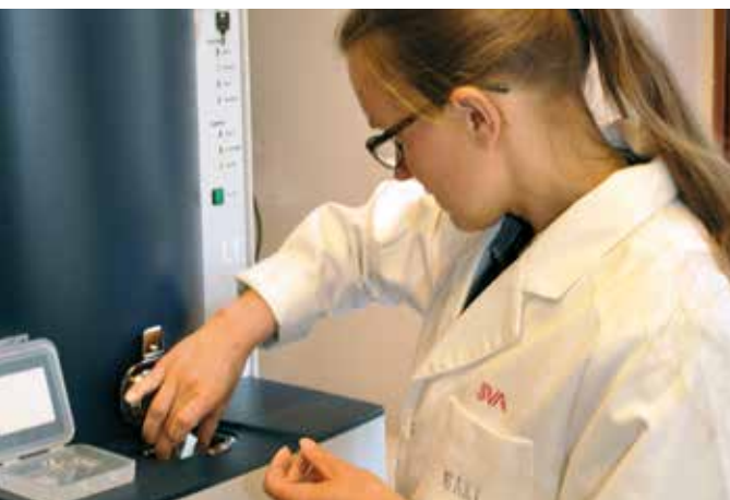
Plattan stoppas in i instrumentet där bakteriens proteiner jonieras genom laserbestrålning och flyger iväg i ett elektriskt fält.
