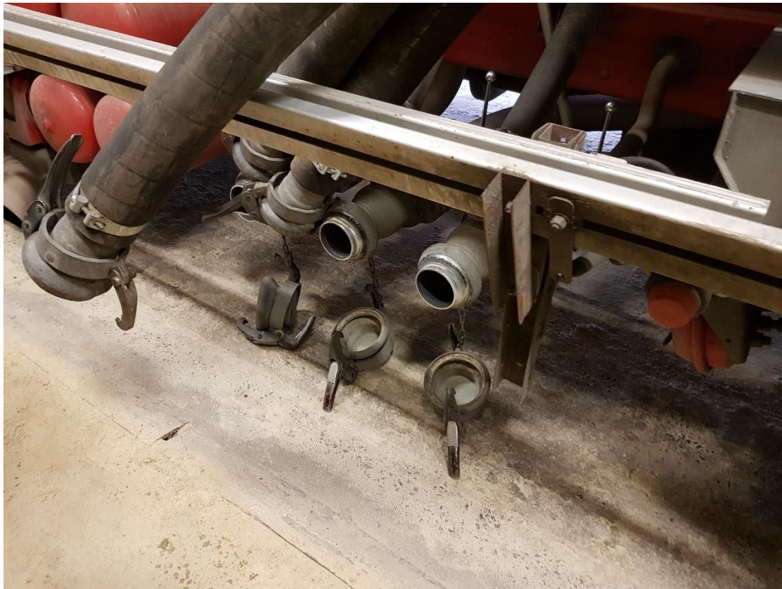
Figur 6. Utblåsrör med lock. Foto: Magnus Thelander
